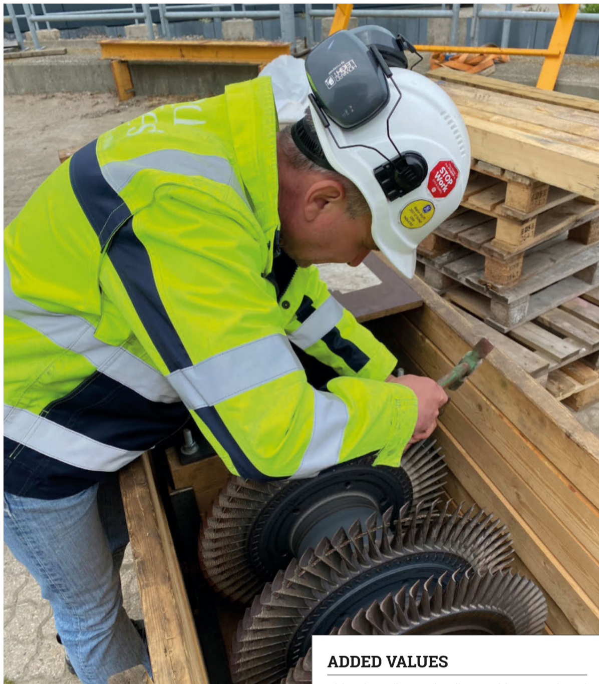
Vi undersøger en turbinerotor for erosions- og korrosionsskader. Fotos leveret af Added Values.
